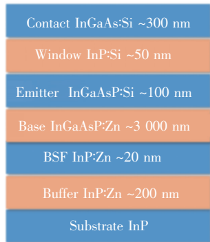
图 4 InGaAsP 单结电池结构示意图
